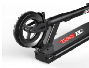
Krok 6: Zdvihnute skladaciu páčku a súčasne posuňte riadiacu tyč smerom od seba, aby ste uvoľnili skladací mechanizmus. Zatlačte riadiacu tyč dole kde sa uzamkne do zloženej polohy.
